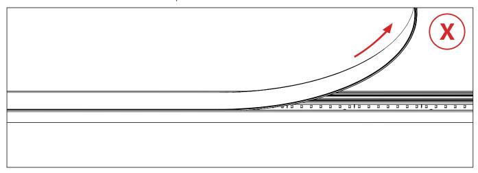
Cortar o difusor com um excedente entre 10 mm por forma a evitar uma fenda com a contracção natural do silicone.
